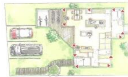
延べ床面積40坪以下の住宅の場合、必要となるevoltzの本数は12本が標準的。
