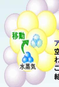
アイシネンの気泡には小さい穴が空いていて、水蒸気が浸入するとわずかに動き外へ送り出します。この動きが水蒸気の吸着を防ぎ、結露の発生を抑えます。
